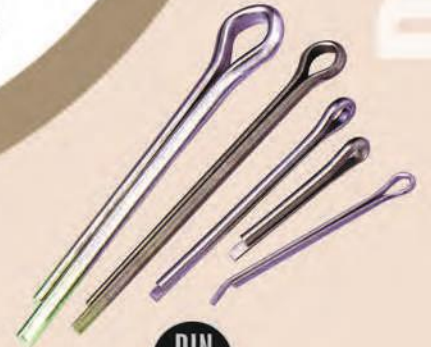
DIN 94 KOPİLYA | SPLIT PINS Anma adı | Thread size | Uzunluk (mm) Lenght 1,5-2-2,5-3-3,5 | 15-20-25-30-35 4-5-6-7-8-10 | 40-45-50-60-70 80-90-100-110-120
